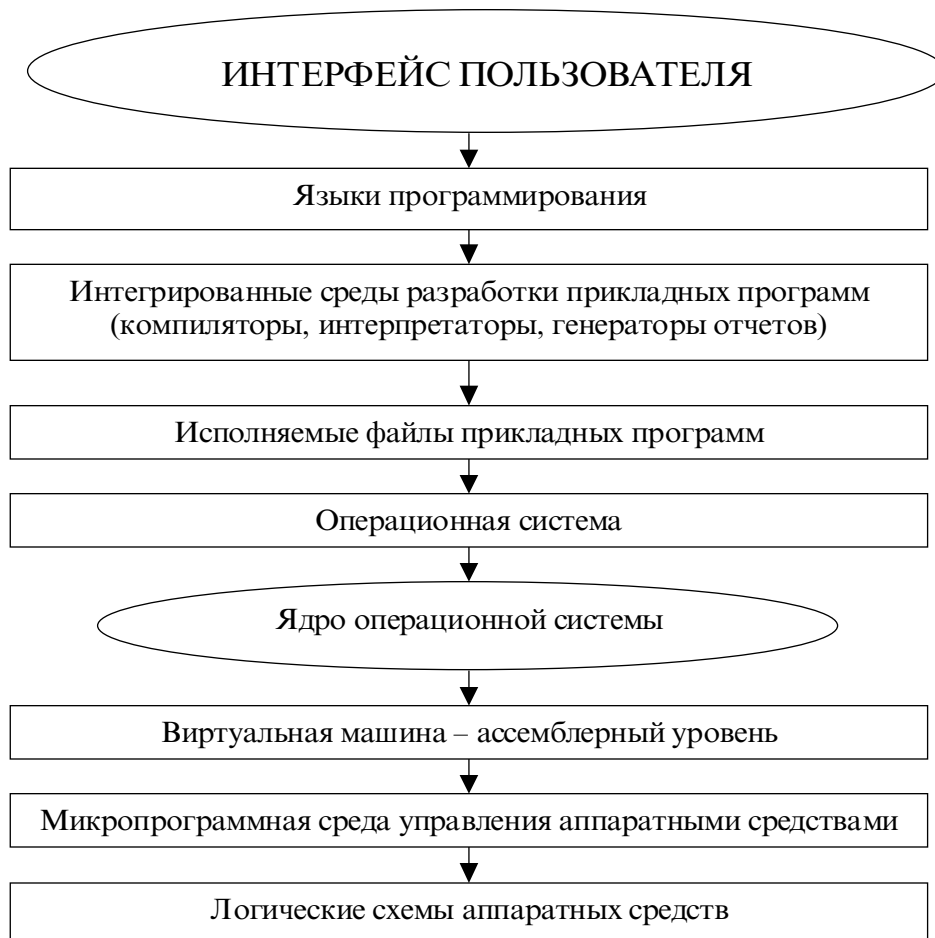
Рис. 2. Схема иерархической модели программно-аппаратных сред ЭВМ
