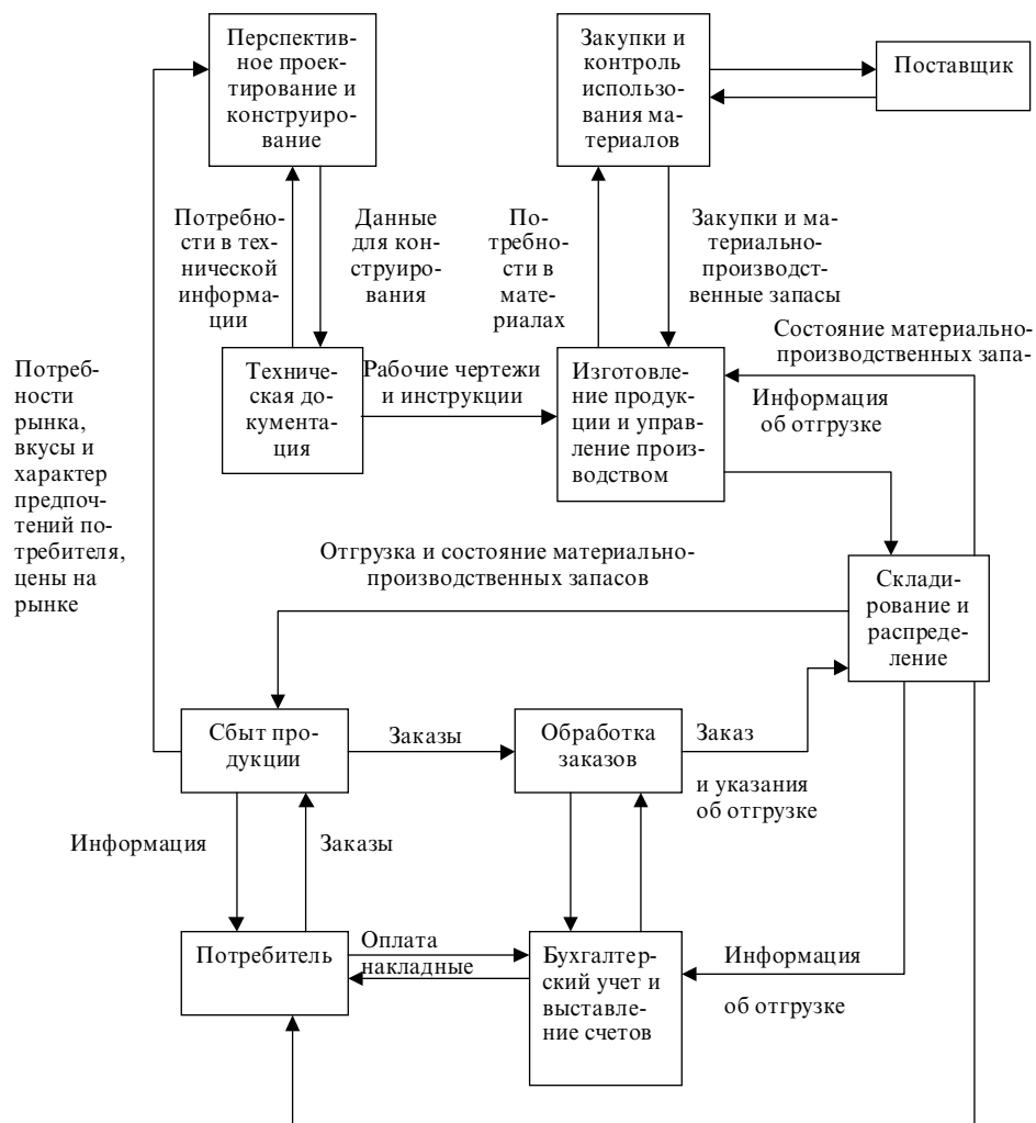
Рис. 3. Схема концепции производственной системы для разработки АИС
