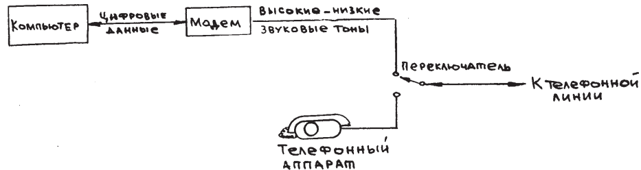
Рис.11. Подключение компьютера к телефонной линии
