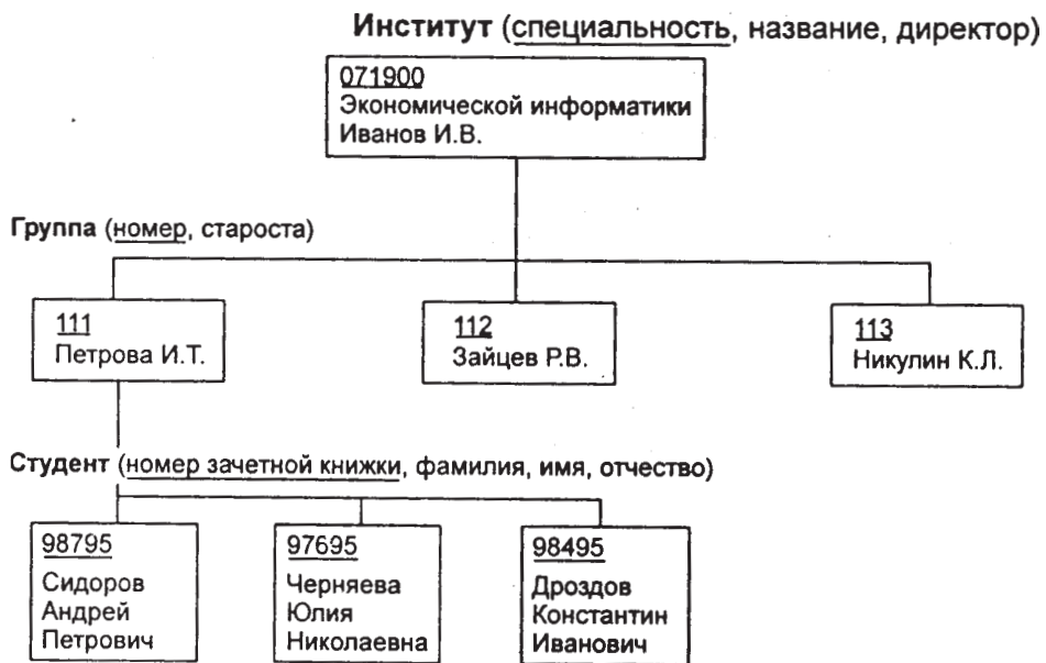
Рис 1.7. Пример иерархической структуры БД
