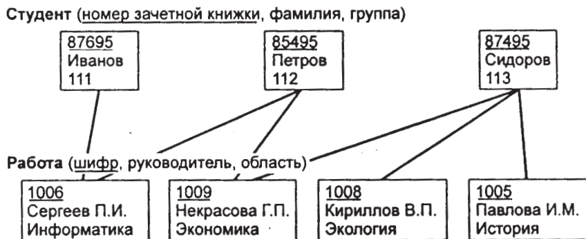
Рис. 1.9. Пример сетевой структуры БД
