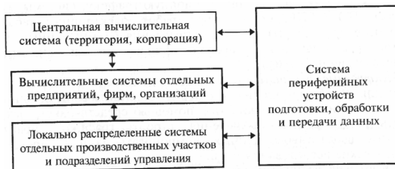
Рис. 4.2. Принципиальная схема многоуровневой организации программно-технических средств ИС
