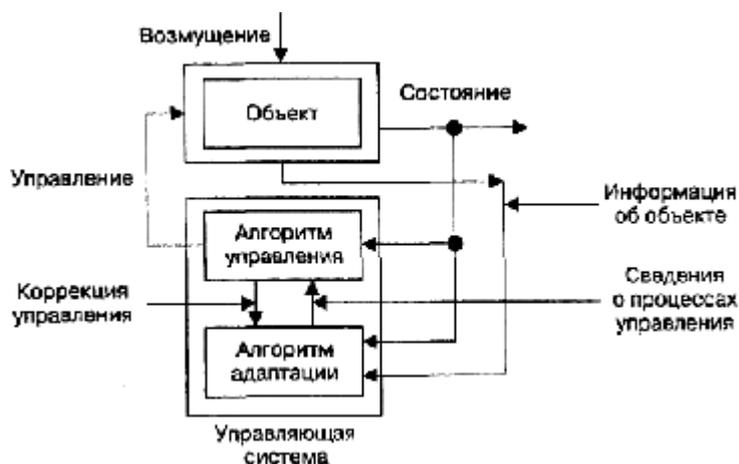
Рис. 4.4. Адаптивная система
