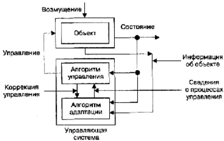
Рис. 4.4. Адаптивная система
