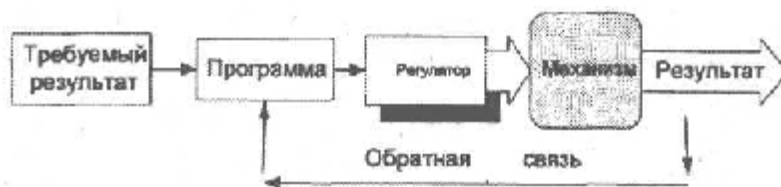
Рис. 1.0.3. Диаграмма процесса автоматического управления работой механизма
