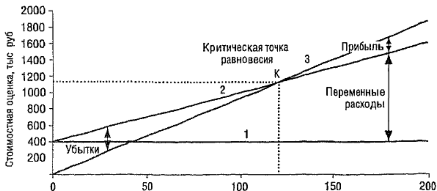
Рис. 8. Зависимость затрат, объема производства и прибыли: 1 — постоянные расходы; 2 — полная себестоимость; 3 — выручка от реализации продукции
