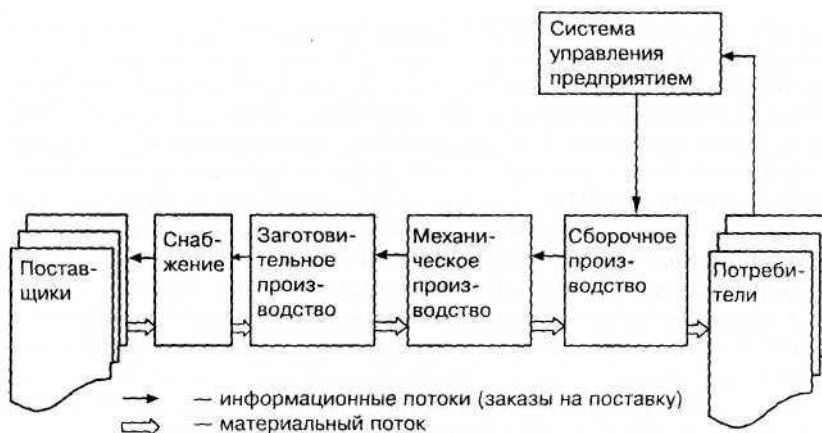
Рис. 17.1. Принципиальная схема работы «тянущей» системы ЛТ
