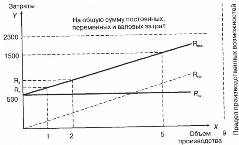
Рис. 2.7. Влияние использования производственных мощностей на затраты при линейной зависимости
